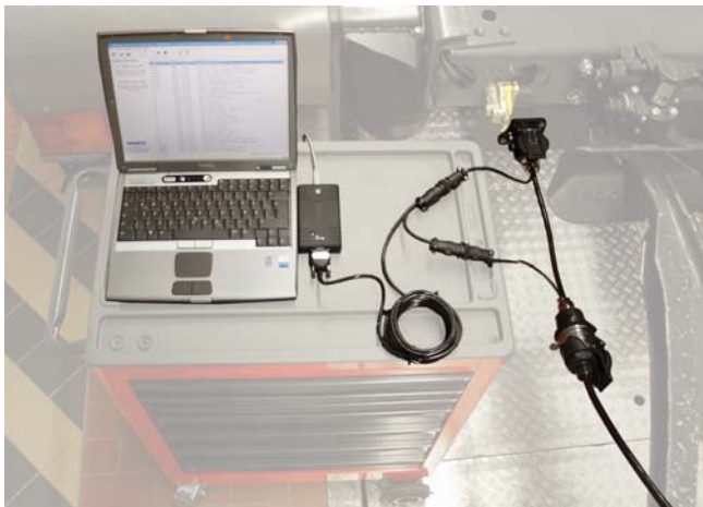
Obr. 3 Kabelové připojení přes ISO 7638
