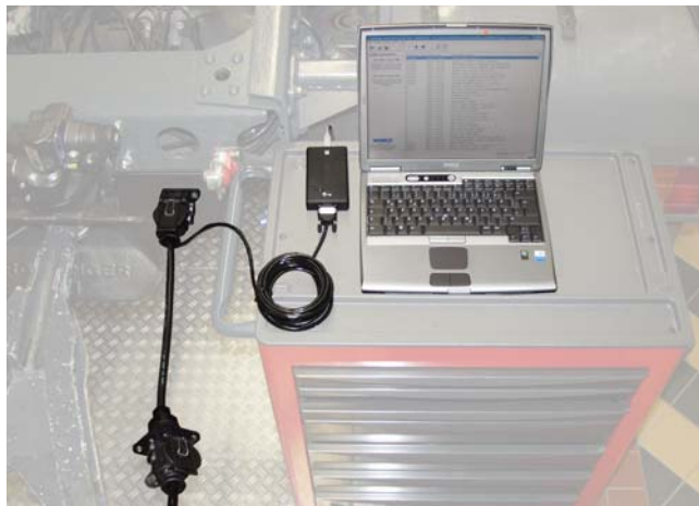
Obr. 4 Kabelové připojení přes ISO 12098
